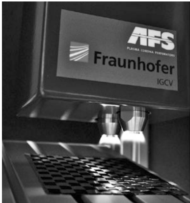
BILD 5 Einfluss der Plasmabehandlungen: Deutliche Entfernung von Restkoks auf unvollständig separierten Halbzeugen (© Fraunhofer IGCV)
