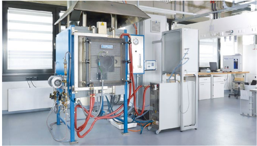
BILD 1 Batch-Ofen zur Pyrolyse von CFK-Strukturen am Fraunhofer IGCV (© IGCV/Uni Augsburg)
